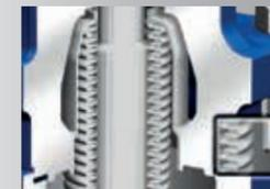
加强波纹管（开关10000次），直接与阀体上部焊接
