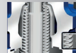
Verstärkter Faltenbalg (10.000 Lastspiele) – am Gehäuseoberteil angeschweißt.
