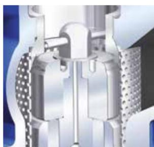
Schallreduzierung durch Strömungsteiler (PREDEX® / PREDU®)
