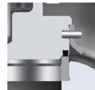
Optimale Dichtheit durch Weichdichtungskegel
