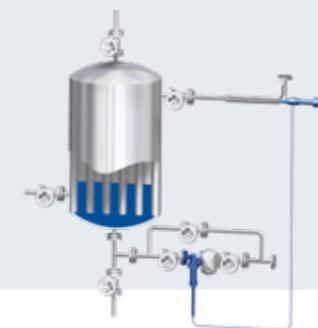
Ventil öffnet bei steigendem Vordruck  $P_1$ .
