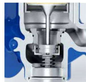
Gehärteter Wendekegel 2 in 1 mit beidseitig geschliffenen Dichtflächen
