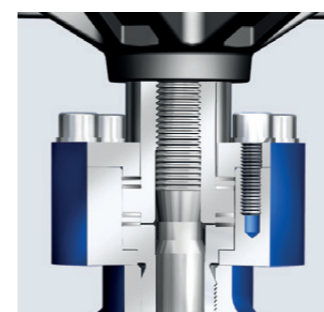
Optimales Handling: nicht steigendes Handrad (PN 63 – 160).
